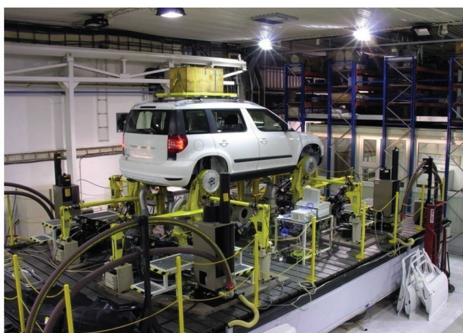
Obr. 45 a 46 Pohled na 16 kanálový simulátor vozovky série 329 (MTS). Fig. 45 and 46 View of the 16 channel road simulator series 329 (MTS).
