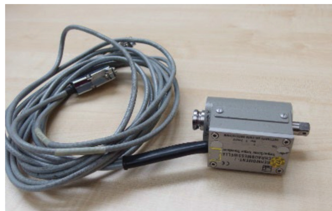
Obr. 28 Pohled na snímač momentu a úhlu natočení. Fig. 28 Torque and rotation angle sensor view.
