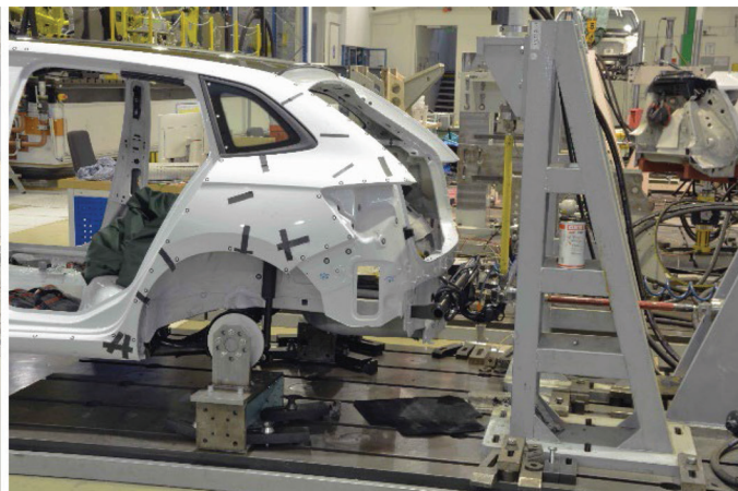
Obr. 40 a 41 – Pohled na uspořádání zkušebního stavu. Fig. 40 and 41 Arrangement of the test bench layout.
