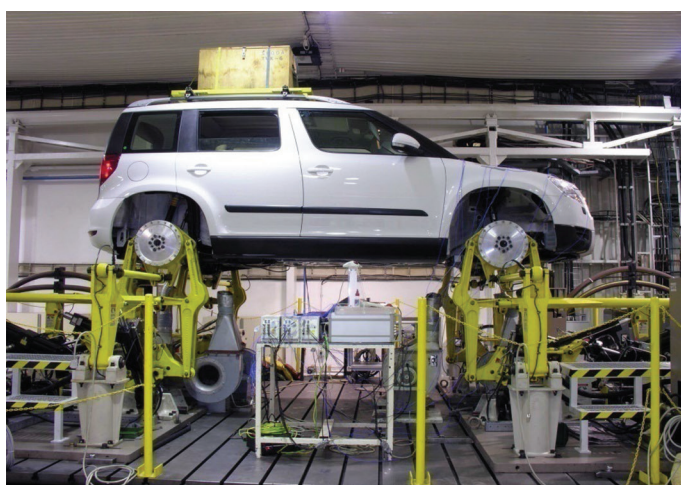
Obr. 45 a 46 Pohled na 16 kanálový simulátor vozovky série 329 (MTS). Fig. 45 and 46 View of the 16 channel road simulator series 329 (MTS).
