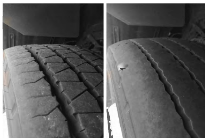
Obr. 4 Fotografie běhounu pneumatik po seřízení sbíhavosti a po ujetí 30 000 km. [3]
