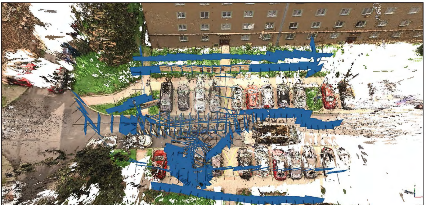
Obr. 4 Pozice snímků při fotogrammetrickém modelování. Fig. 4 Camera positions from photogrammetry modelling.
