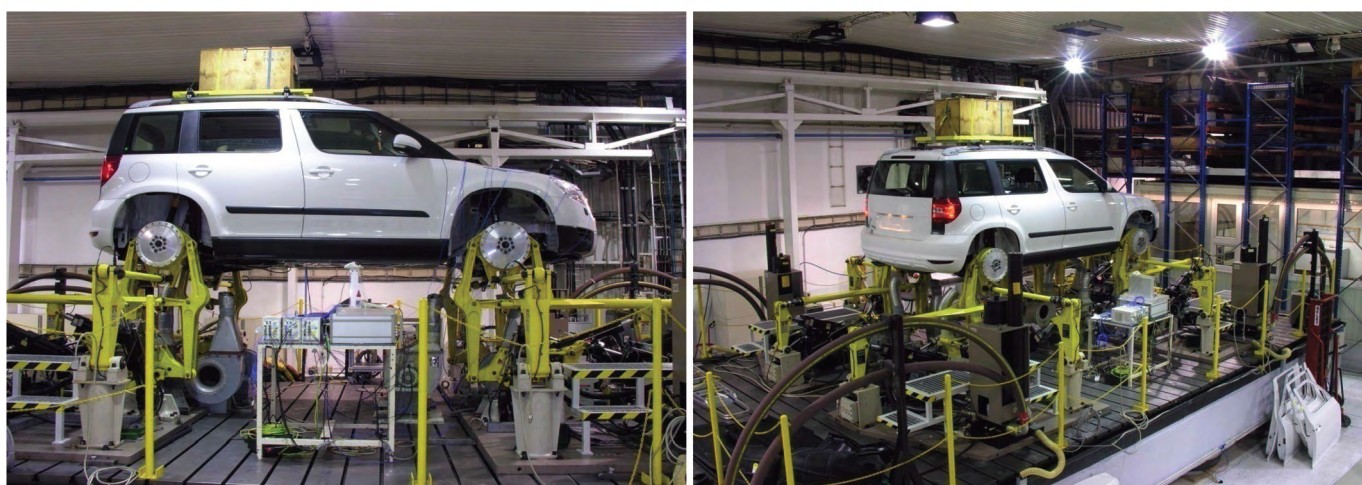
Obr. 45 a 46 Pohled na 16 kanálový simulátor vozovky série 329 (MTS). Fig. 45 and 46 View of the 16 channel road simulator series 329 (MTS).
