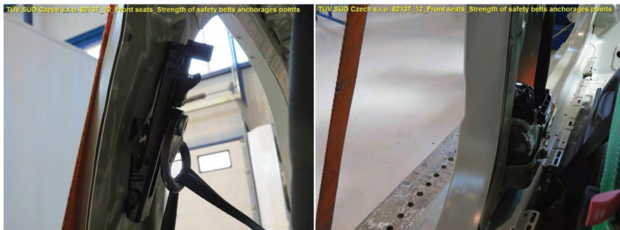
Obr. 9 a 10 Stav úchytů pasů levé přední sedačky po zkoušce. Fig. 9 and 10 Condition of the left front seat attachments after the test.
