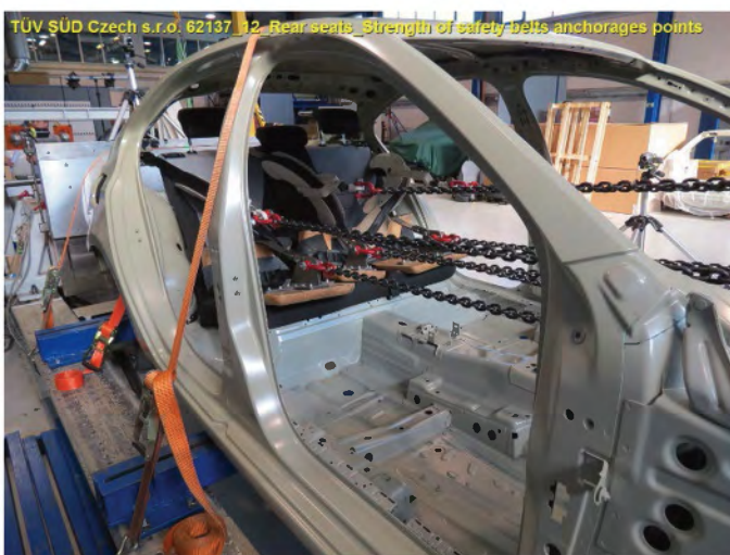
Obr. 5 a 6 Uspořádání zkoušky úchytů předních a zadních bezp. pasů. Fig. 5 and 6 Front and rear seat belts fittings test arrangement.
