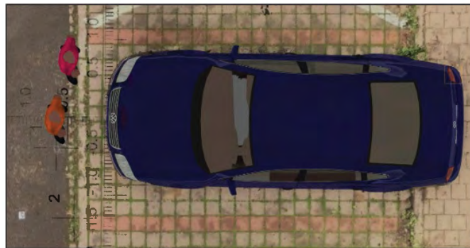
Obr. 10 Porovnání postavení chodce dle prvního znalce a dle záznamu palubní kamery. Fig. 10 Comparison of pedestrian's position according to the first expert and dash camera recording.
