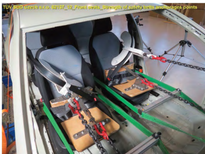
Obr. 5 a 6 Uspořádání zkoušky úchytů předních a zadních bezp. pasů. Fig. 5 and 6 Front and rear seat belts fittings test arrangement.
