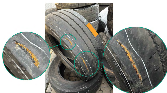
Obr. 5 Opotřebení pravé přední pneumatiky po 66 139 km. Je viditelný odhalený první nárazník. [2]
