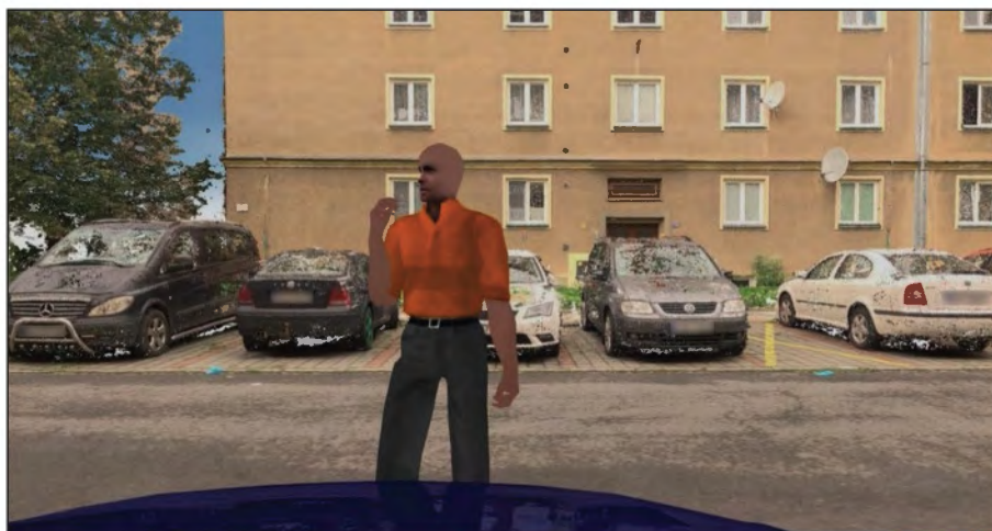
Obr. 5 Postavení chodce v simulačním programu vůči bodovému mračnu okolí. Fig. 5 Pedestrian's position in simulation software in relation to point cloud of the scene.
