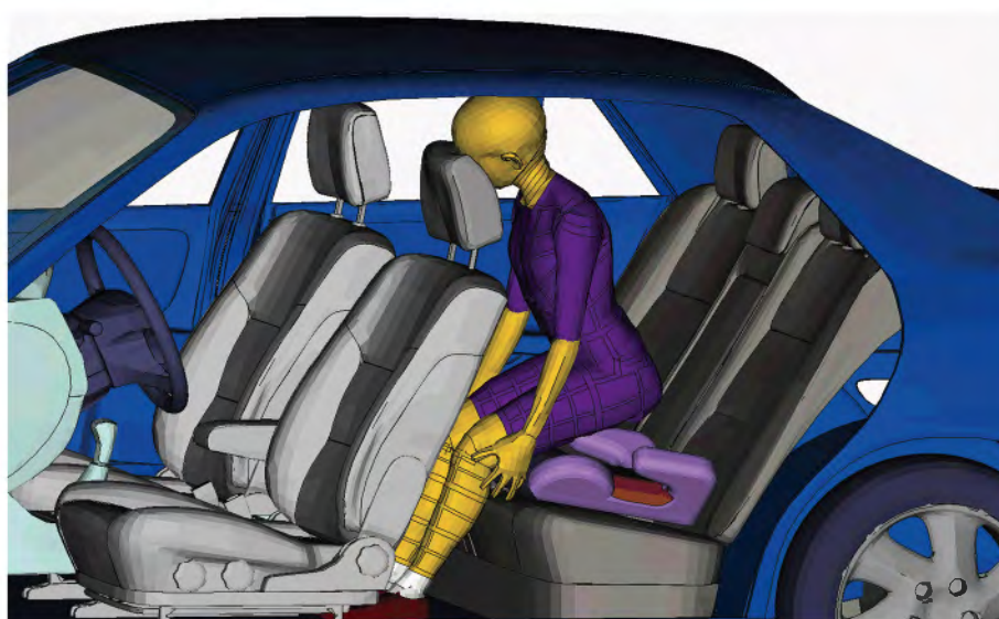
Obr. 29 Kontakt hlavy chlapce a hlavovou opěrkou řidiče, varianta 3B, rychlost 36 km/h, čas cca 120 ms, boční pohled.
