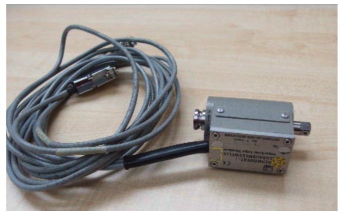
Obr. 28 Pohled na snímač momentu a úhlu natočení. Fig. 28 Torque and rotation angle sensor view.
