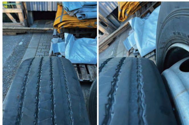
Obr. 8 Opotřebení předních pneumatik po sundání po 143 367 km provozu s mírně zvýšenou sbíhavostí. Fig. 8 Wear of front tires after 143 367 km of usage with middle toe-in settings.
