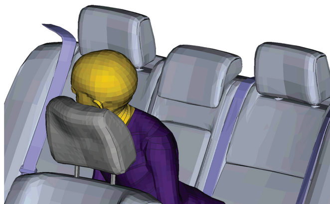
Obr. 31 Závěrečná fáze kontaktu hlavy chlapce s hlavovou opěrkou řidiče, varianta 3B, rychlost 36 km/h, čas cca 150 ms, detail. Fig. 31 The final phase of contact of the boy's head with the driver's headrest, variant 3B, speed 36 kph, time approx. 150 ms, detail.
