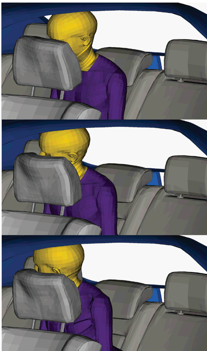
Obr. 30 Průběh kontaktu hlavy chlapce s hlavovou opěrkou řidiče, varianta 3B, rychlost 36 km/h, čas 120–130–140 ms, detail. Fig. 30 Course of contact of the boy's head with the driver's headrest, variant 3B, speed 36 kph, time 120–130–140 ms.
