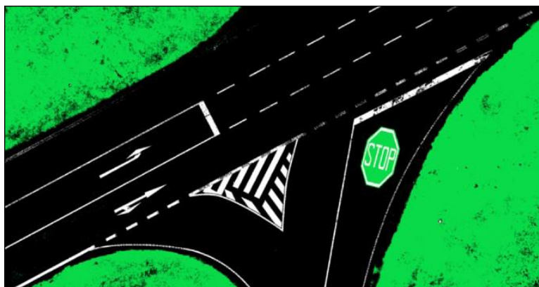
Obrázek 3 Počáteční barevná segmentace obrazu se zvýrazněným vodorovným dopravním značením, povrchem vozovky a segmentovanými úseky [autor]
