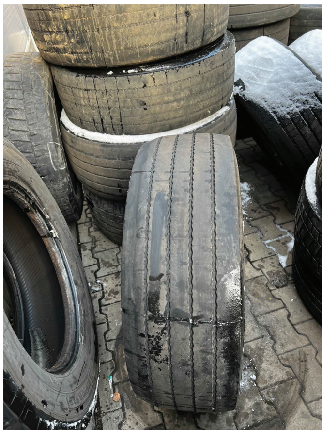
Obr. 6 Opotřebení levé přední pneumatiky po 66 139 km. Je viditelné silně asymetrické opotřebení v oblasti vnějšího ramene. Fig. 6 Wear of front left tire after 66 139 km of usage. There is strong asymmetric shoulder wear visible on the outer side.
