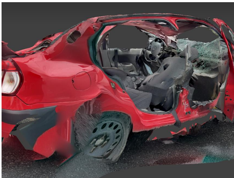
Obrázek 6 Chyba v podobě posunu textury na dokumentovaném modelu vozidla (aplikace Scaniverse) [Autor]
