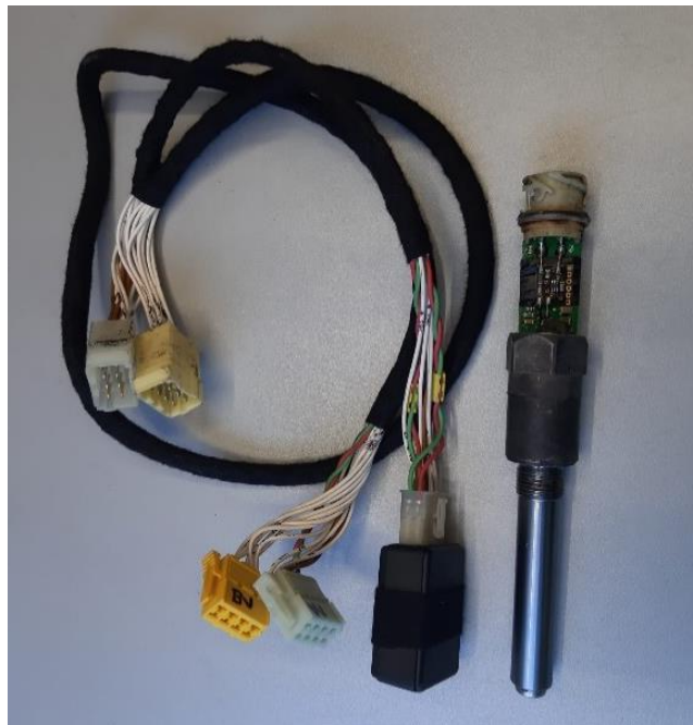
Obrázek 3 Snímač pohybu a manipulační zařízení v černém pouzdru [autor]
